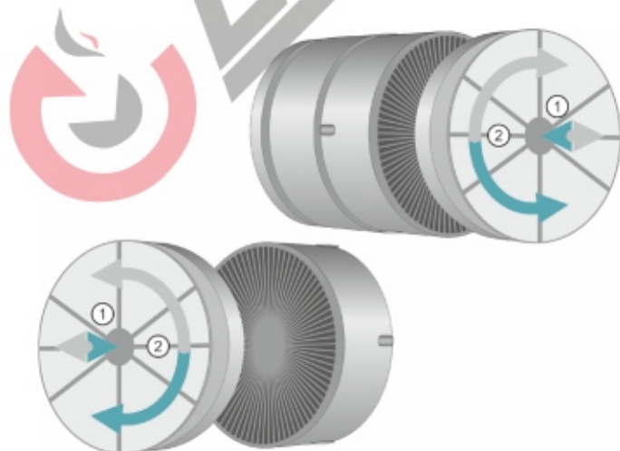
Рис. 14 Установка угольного фильтра
